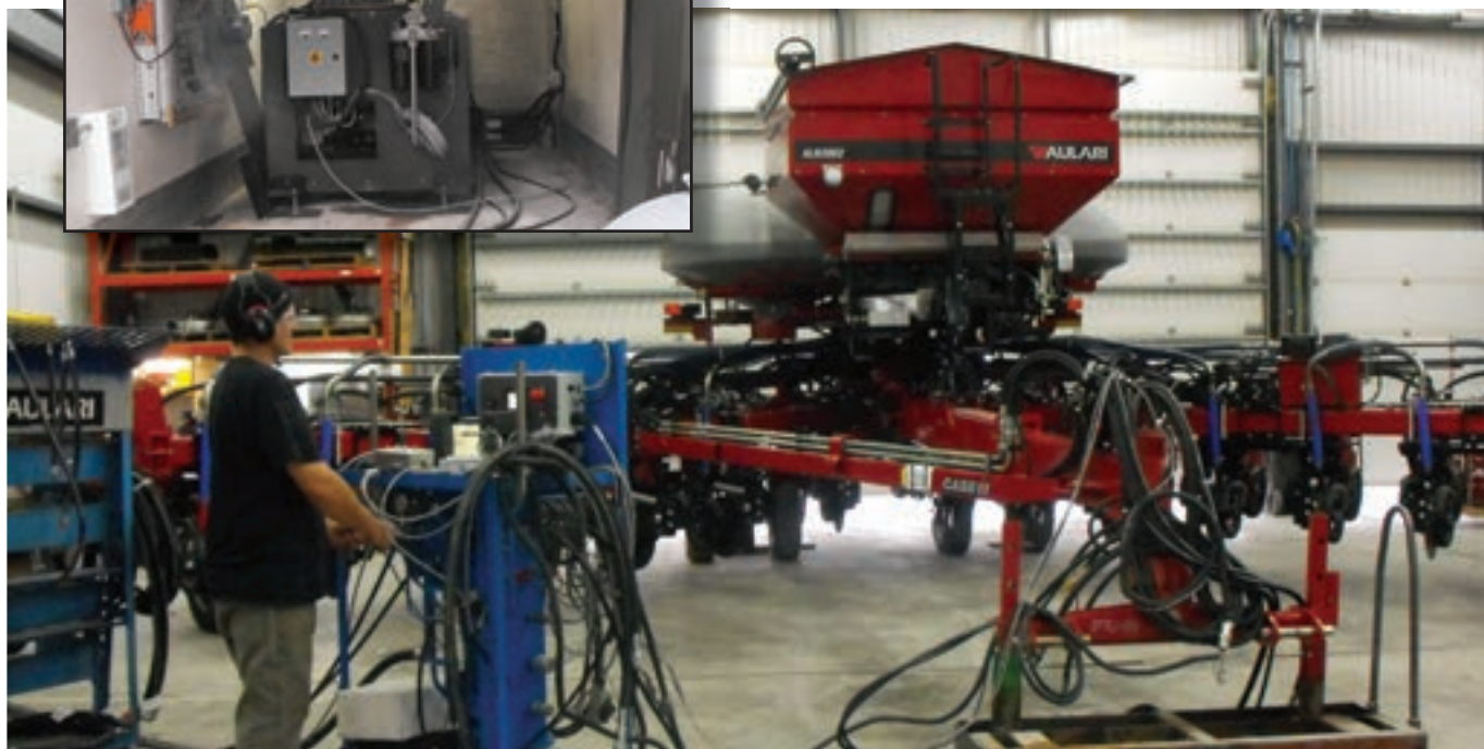
Unité stationnaire du banc d'essai de la machinerie, située à l'extérieur de l'usine, dans une remorque isolée (voir photo en médaillon), avec contrôle complet depuis l'intérieur : une amélioration majeure.
