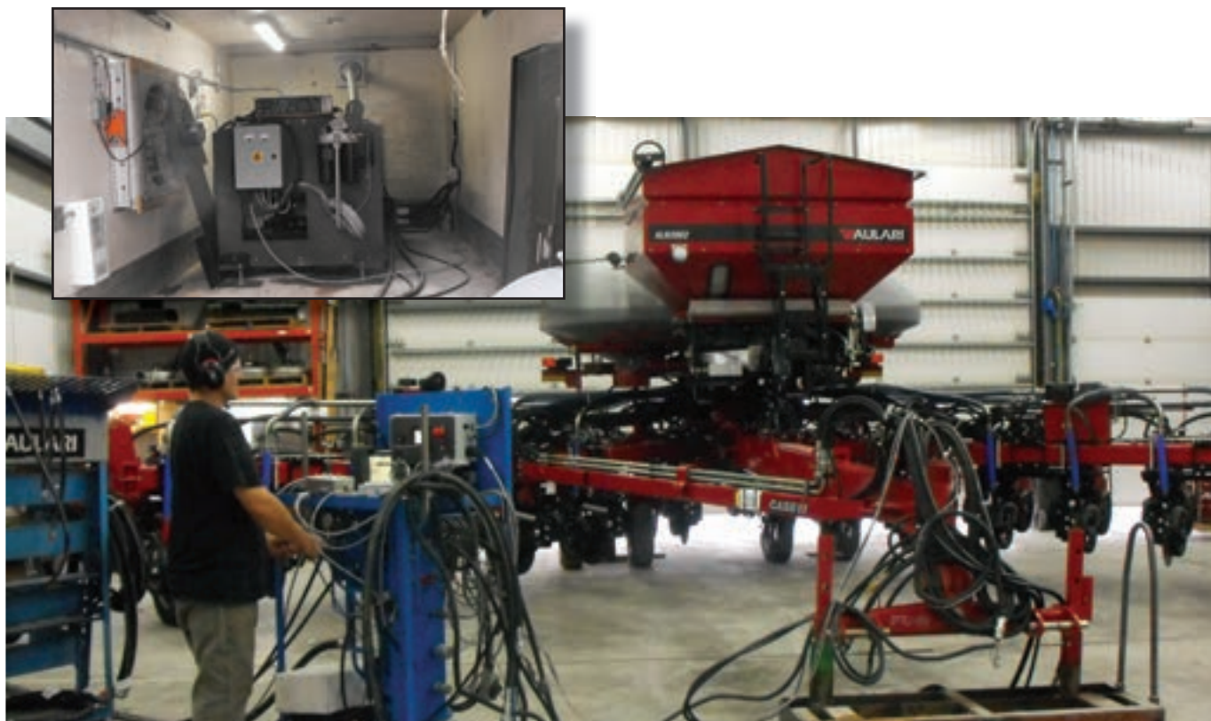
Unité stationnaire du banc d'essai de la machinerie, située à l'extérieur de l'usine, dans une remorque isolée (voir photo en médaillon), avec contrôle complet depuis l'intérieur : une amélioration majeure.
